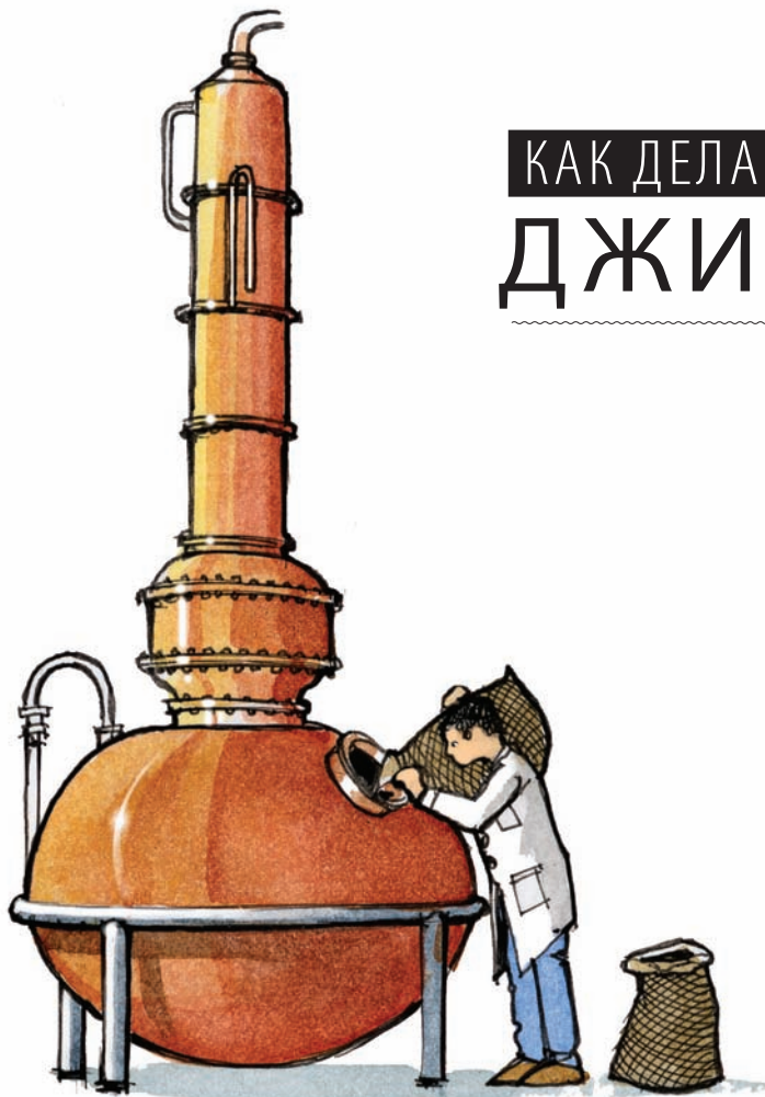
2. Можжевельную ягоду и другие пряности (кориандр, миндаль, лимонные корочки и т.д.) дистиллируют со спиртом, разбавленным водой до 45% vol.
