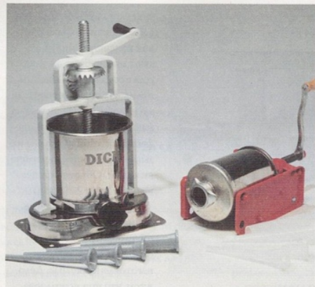
Шприцы для набивки — вертикальный и горизонтальный
