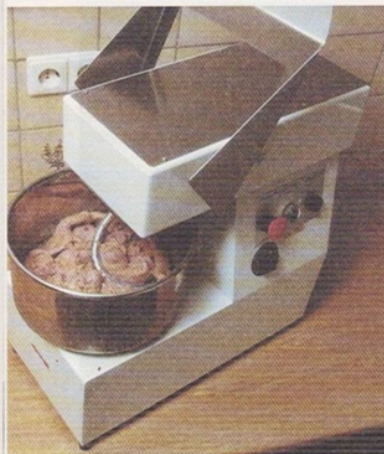
Вымешивание колбасного фарша с помощью тестомесильной машины
